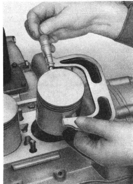
Bild M 42. Unrundung am Kolben feststellen
