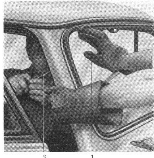
Bild K 15. Frontscheibe einbauen ohne Verwendung der Sondervorrichtung
