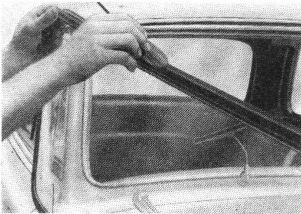
Bild K 12. Einstreichen des Profilgummis vor dem Einsetzen
